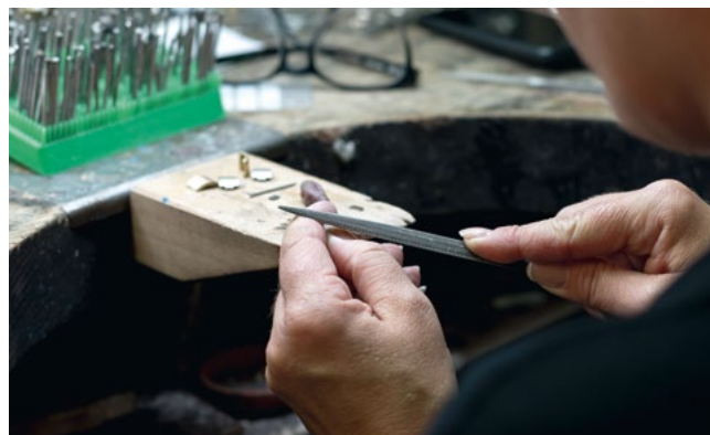
Am «Feilnagel» werden die zierlichen Bestandteile eines Schmuckstücks gebogen, gesägt und gefeilt.
